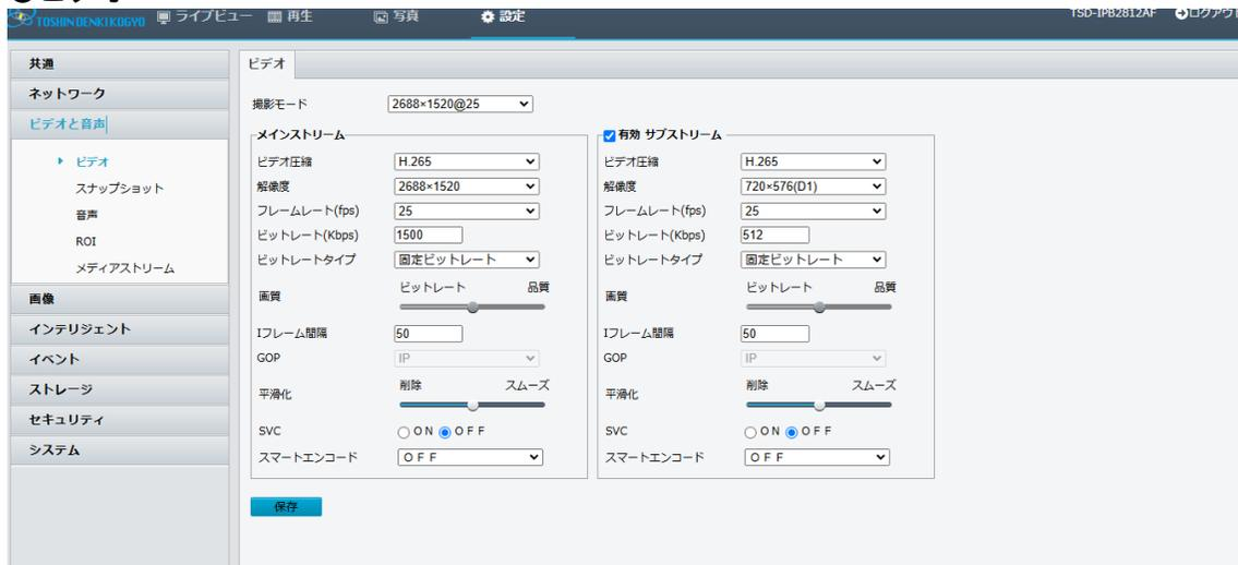
撮影モード:撮影するカメラ解像度とフレームレートを選択します。
