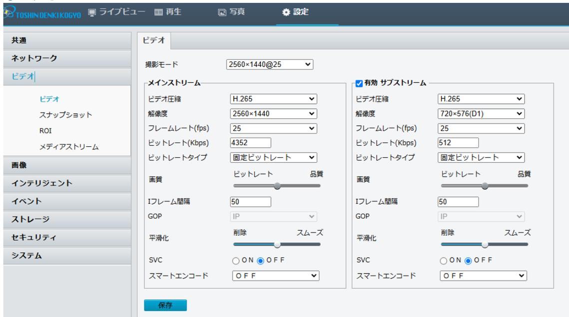
撮影モード:撮影するカメラ解像度とフレームレートを選択します。
