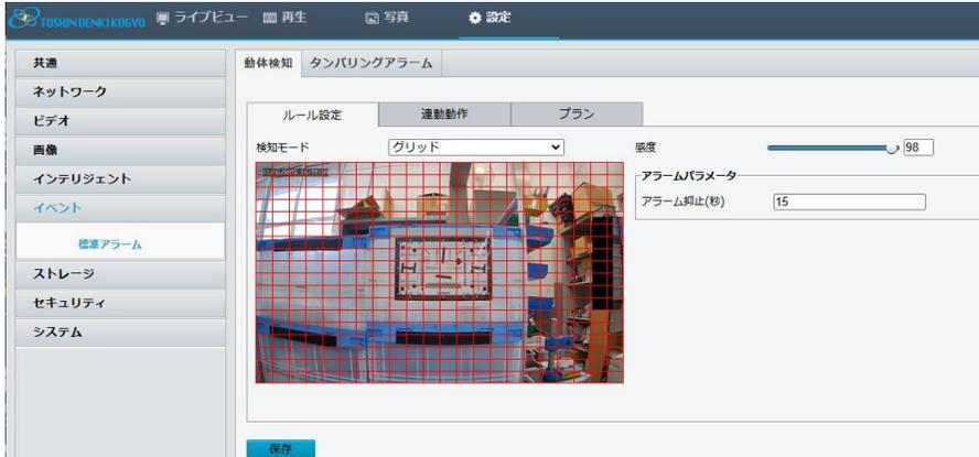
動体検知、改ざんアラーム、音声検知などのイベントによる動作内容を設定します。
